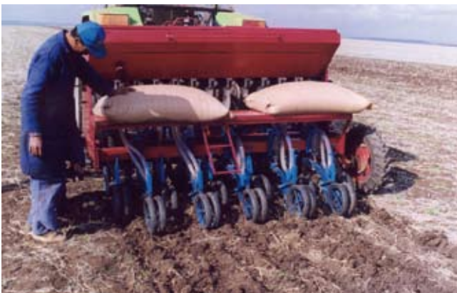
Figure7: Semoir direct combiné IAV Hassan II au travail dans la région de Zaers (primé par R&D Maroc en 1999)
