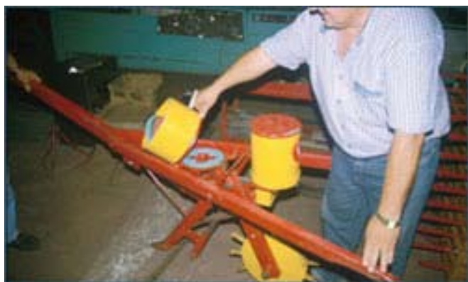
Planche 50. Plateau d'un semoir motorisé standard utilisé dans un semoir attelé simple (T. Friedrich)
