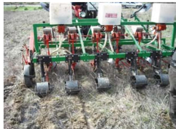
Figure 8 : Les deux semoirs directs, tracté et à traction animale conçus et fabriqués en France et expérimentés actuellement au Maroc (Coopérative de Bouhsousen, Khénifra, FERT-ENA-IAV)
