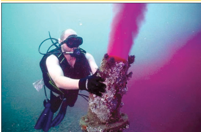
Figure 5: Test de validation du modèle de diffusion par traçage hydraulique à la rhodamine des concentrats de l'installation de Perth [4]
