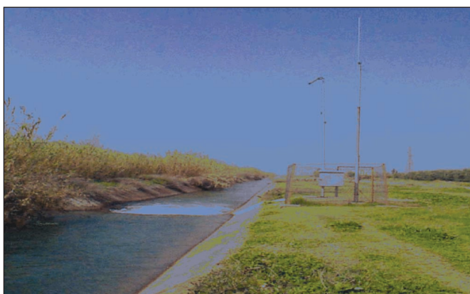
Photo n°2 : point de mesure de débit en temps réel (au départ du canal Médian Oust (10 m 3 /s)
